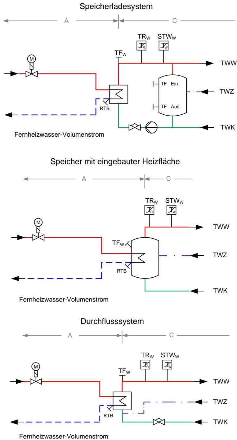
Abbildung 13: Hauszentrale-Trinkwassererwärmung
