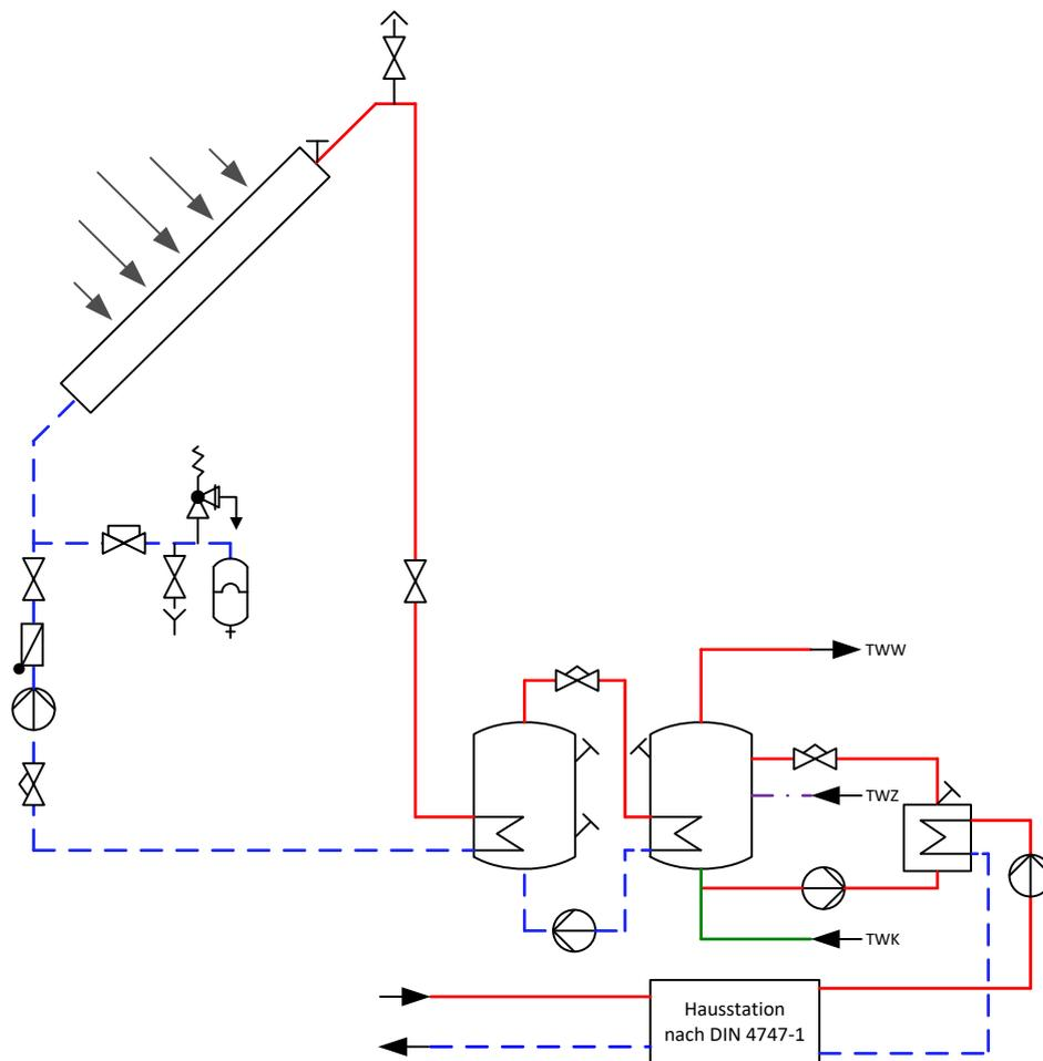
Abbildung 18: Solaranlage mit Pufferspeicher und Trinkwassererwärmer mit außen liegendem Wärmeübertrager für die Nachheizung
